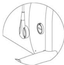
Se il led sul caricabatteria è verde significa che le batterie sono completamente cariche. Il caricatore può rimanere collegato anche se le batterie sono già completamente cariche. Togliete il caricatore dalla presa e staccare la sedia Elexo. La sedia Elexo dopo l'attivazione (cfr. paragrafo Mettere in funzione) è pronta per l'uso.
