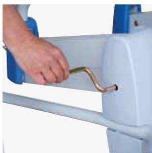
*Dispositivo di abbassamento d'emergenza.*
